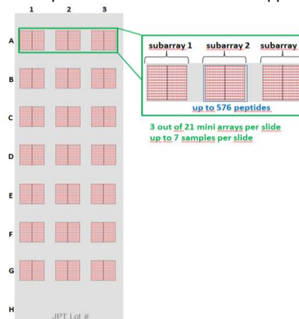
figure 1: Multiwell array format: 21 mini arrays per slide. Each mini array displays all peptides in one individual spot
