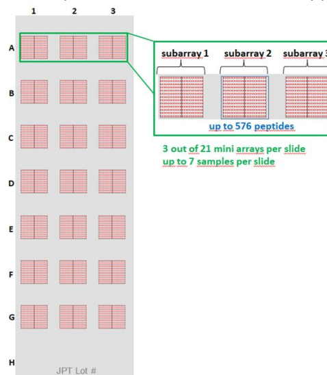
figure 1: Multiwell array format: 21 mini arrays per slide. Each mini array displays all peptides in one individual spot
